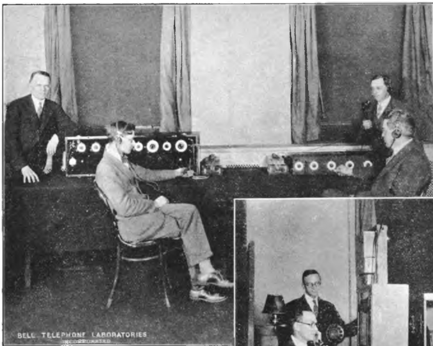
Boven. Ontvang-apparatuur voor draadloos zien. De foto is genomen tijdens de finale proef in het laboratorium. In het midden, tusschen de gordijnen, een transparant waarachter de neon-buis is opgesteld.
